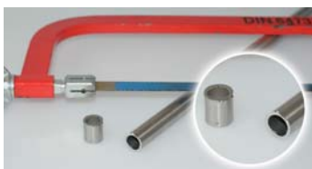
Ergebnis Bügelsäge (Grat außen und innen)
